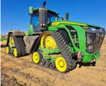
Die John Deere 9RX830 is Afrika se grootste trekker — 38 ton en 610–680 kW wat reuse werktuie moeiteloos trek.
