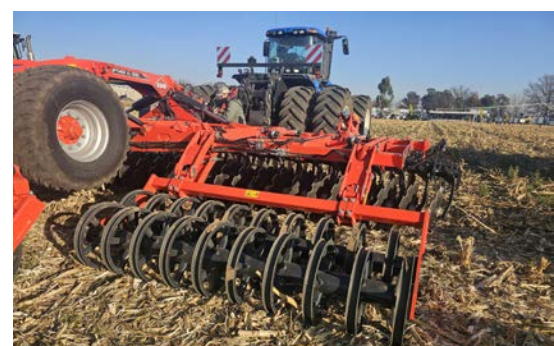
Die Optimer 9000 kan met een van vyf soorte rollers aangekoop word. Hier is die dubbel-U-rollers vir 'n wye reeks grondtoestande.
