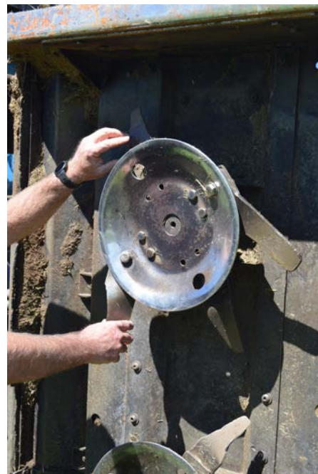
Die Major Cyclone werk anders as ander snyers omdat hy 'n tweede stel lemme het wat lang gesnyde gras nog fyner kap vir 'n deklaag.
