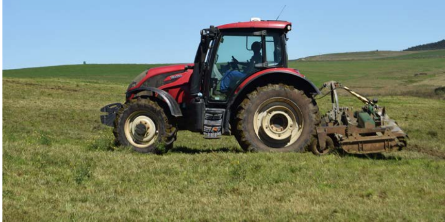
Die Major Cyclone werk anders as ander snyers omdat hy 'n tweede stel lemme het wat lang gesnyde gras nog fyner kap vir 'n deklaag.
